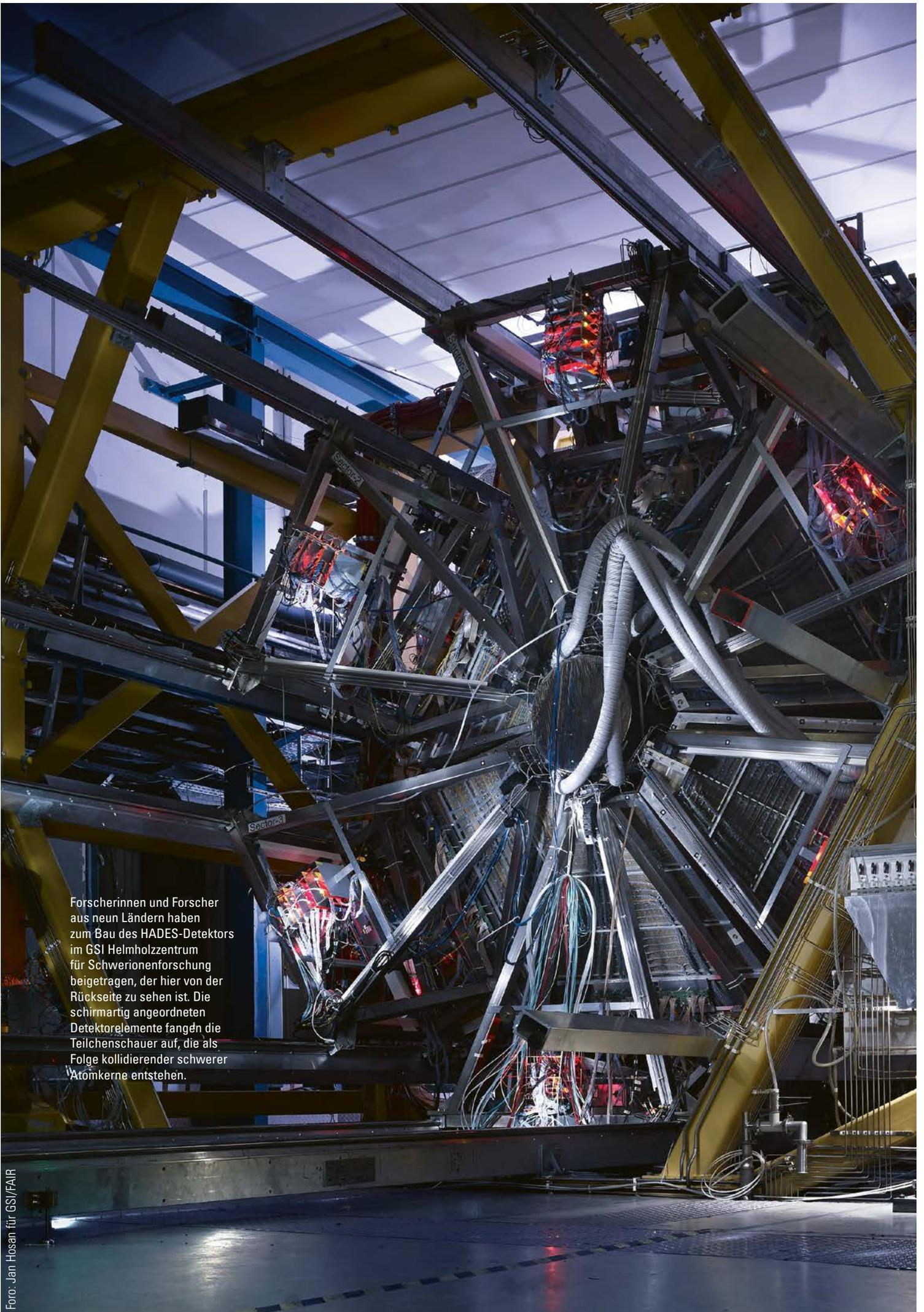
Forscherinnen und Forscher aus neun Ländern haben zum Bau des HADES-Detektors im GSI Helmholtzzentrum für Schwerionenforschung beigetragen, der hier von der Rückseite zu sehen ist. Die schirmartig angeordneten Detektorelemente fangen die Teilchenschauer auf, die als Folge kollidierender schwerer Atomkerne entstehen.
